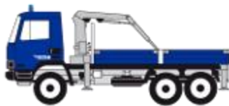
Ladekran 78 mT gl Seitliche Auslage max. 20 m
